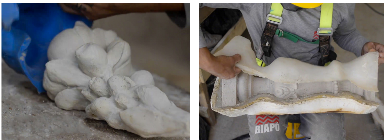
Moldes de silicone reproduzem fielmente objetos ornamentais a partir de um modelo
