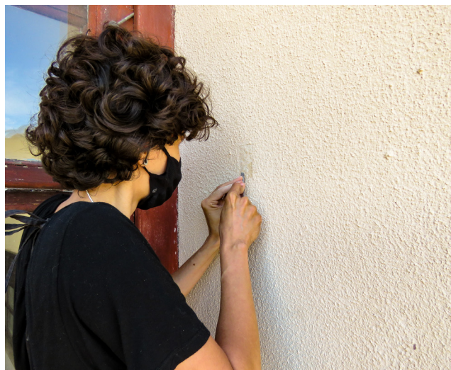
Testes manuais e de prospecção contribuíram para avaliar a melhor técnica de remoção e verificar camadas de pinturas subjacentes, respectivamente
