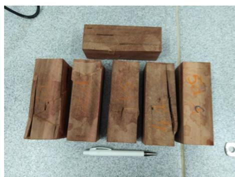
*Amostras de maçaranduba após ensaio de rompimento à compressão axial*
