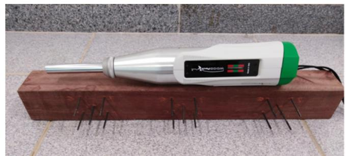
*Utilização de esclerômetro/penetrômetro WoodPecker em corpo de prova de maçaranduba - etapa 1 do projeto*
